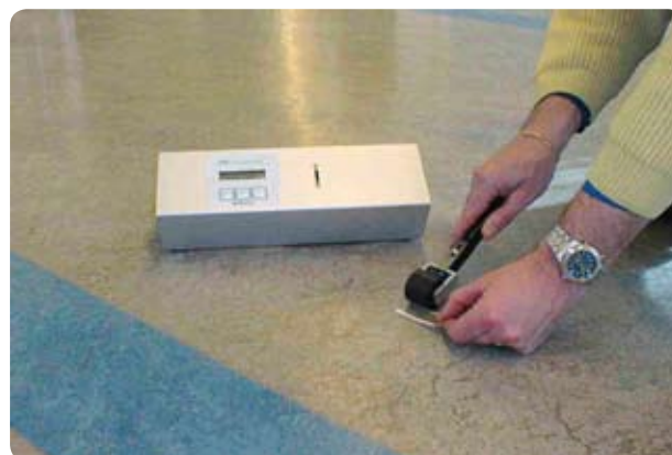
Fig. 73 Støvmåling på golv. Foto: SINTEF Byggforsk
