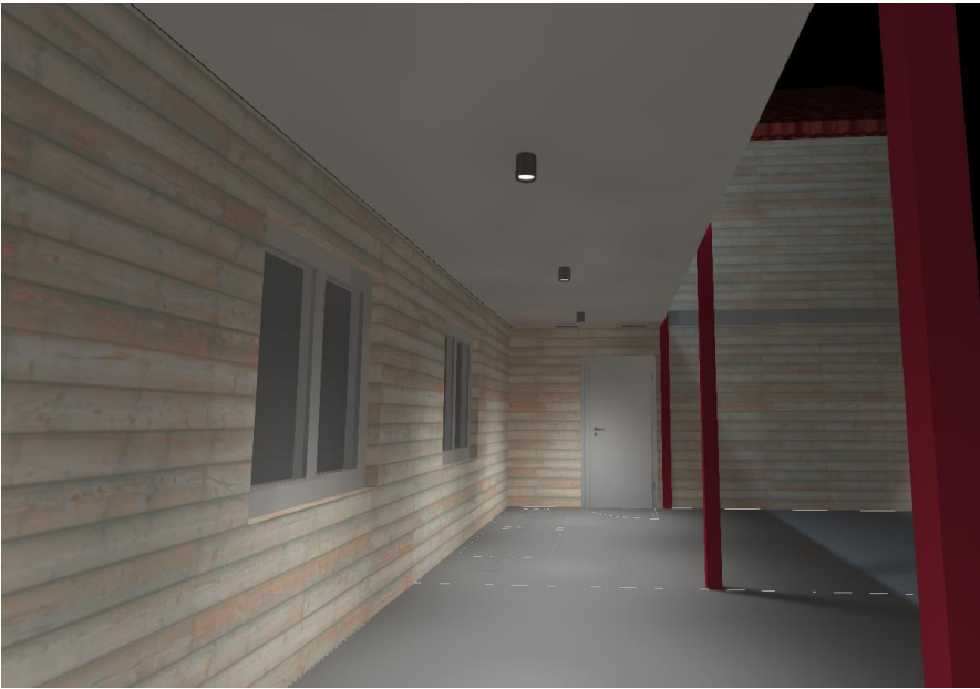
3 Utklipp fra lysberegning som viser utepåliggende downlights
