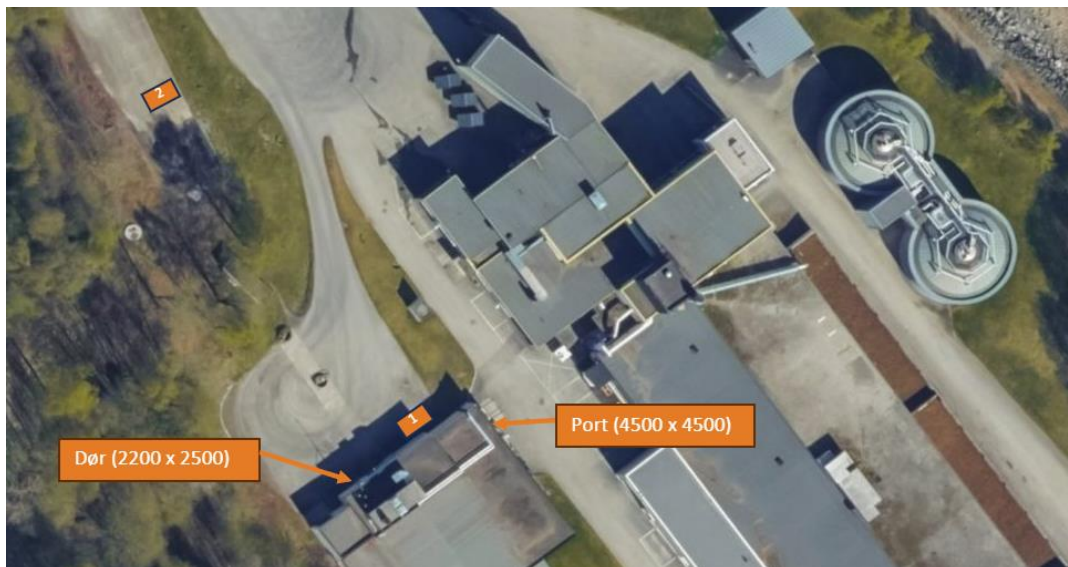
Figur 1. Septikmottak foreligger på området foran dør (2200x2500). Det vil bli levert septik i anleggsfasen. Det er avsatt areal (1) for utstyrskontainer som vist (rektangel er ca. 2200 x 4500 m). Det vil være mulig å etablere spisebrakke (2) på gjesteparkering (rektangel er ca. 2200 x 4500 m).
