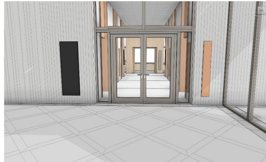
Oversiktsskilt (600 x 1800) ved inngang til heis- og trapperom
