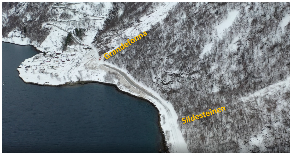
Figur 5. Grande, Grandefonna og Sildesteinen. Grå snøoverflate ned mot fjorden viser hvor langt ned skredmassene fra Grandefonna gled langs vegen i retning Sildesteinen 17. januar 2019. Foto fra 31. januar, Halgeir Dahle.
