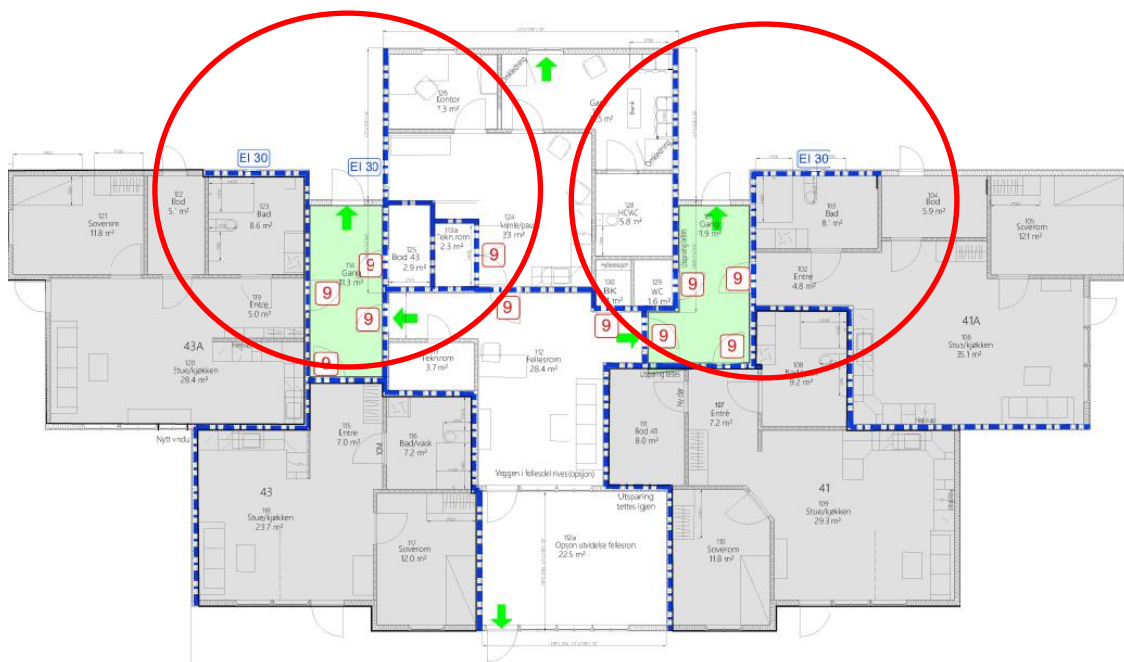
Figur 5: Skjerming av rømningsvei.
