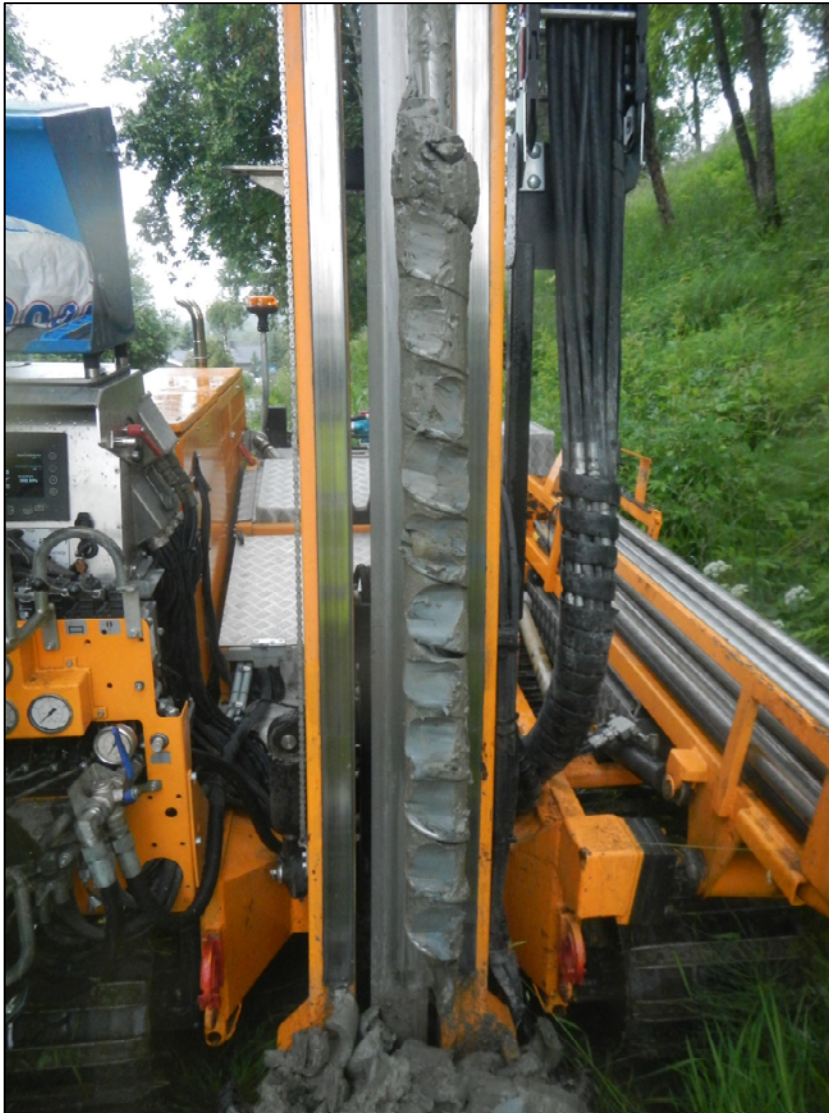
Figur 11. Skovl fra prøvepunkt GL15 3-4 meter, hvor det er registrert fyllmasse leire over antatt naturlig leire. Foto datert 1. juli 2019.
