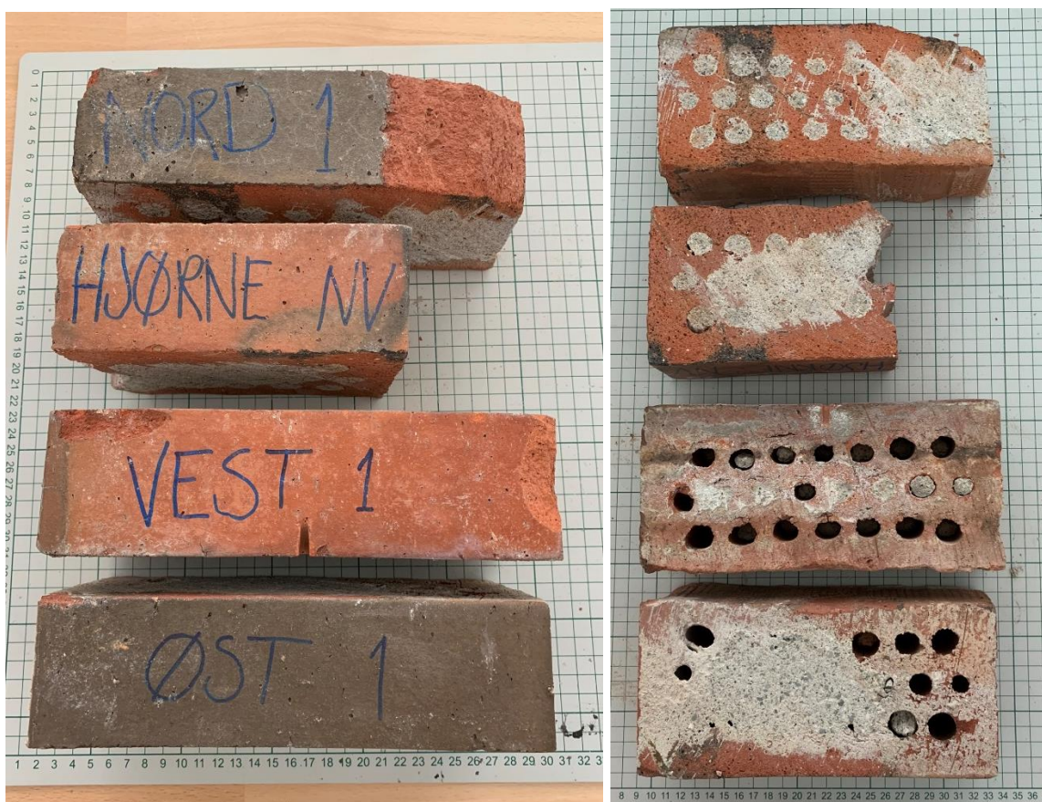
Figur 2. Prøver efter forsøg med afrensning af mørtel. Prøve "Vest 1" (tredje fra oven) er håndrenset med hammer og mejsel. For øvrige prøver er mørtlen savet af med diamantklinge. Omkring midten af de savede flader ses en del mørtelrester fordi murstenens liggeflade er konveks.
