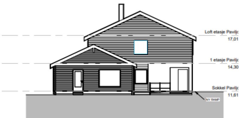
Figur 3 Opsjon 2. Bytte alle vinduer som ikke allerede ligger inne i prosjektet. De som uansett skal byttes og derfor ikke er en del av opsjonen er markert med blå i fasade tegninger
