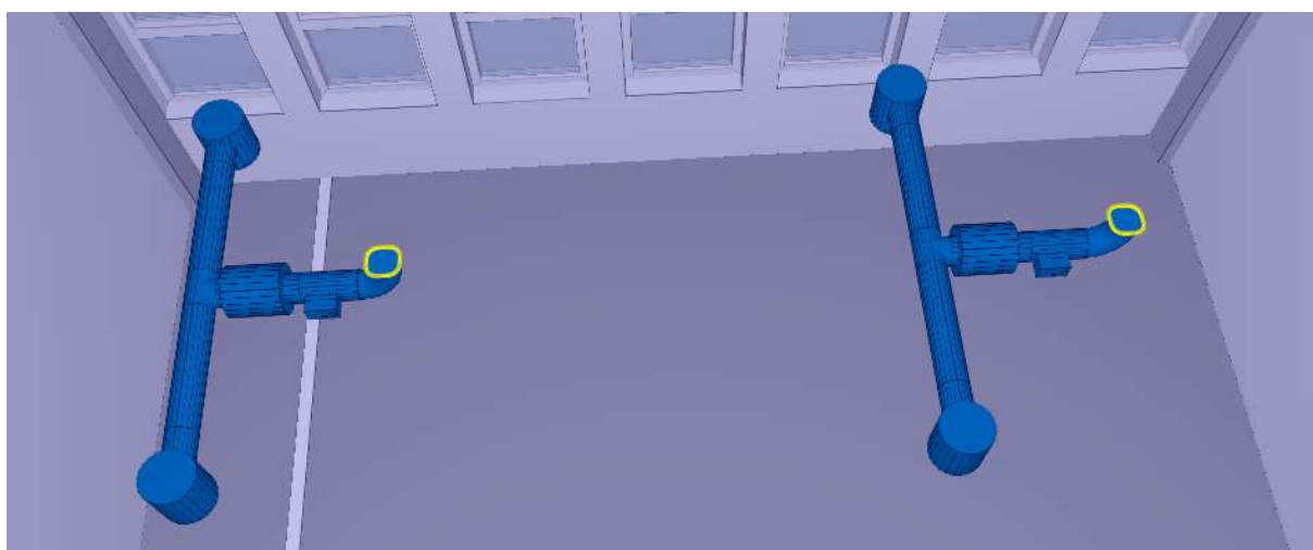
Figur 17 - Nye tilluftsventiler tilknyttet eksisterende kanaler ført på tak
