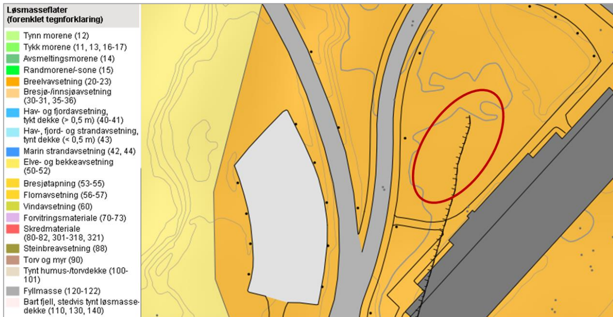
Figur 1: NGUs løsmassekart [2] viser breelvasetninger på tomten, og elveavsetninger langs elveløpet vest for tomten. Omtrentlig plassering av bygg er merket med rødt.
