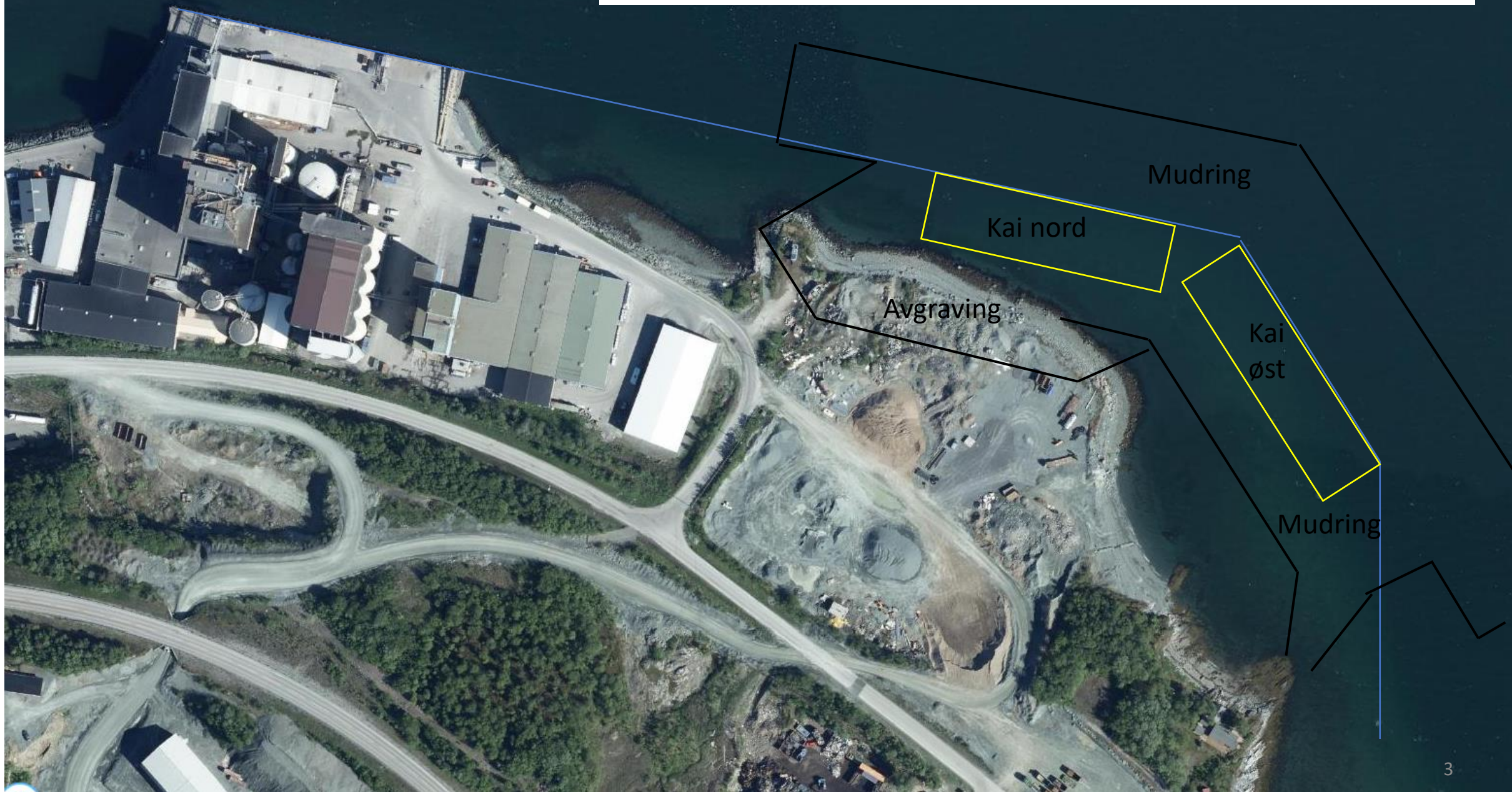
Skissert mudringsutstrekning ved pelede kaier og steinsjeté for fylling
