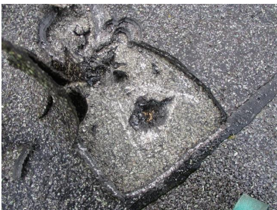
Bilde 6: Asfaltapp. Ikke asbestholdig. Prøve P26c
