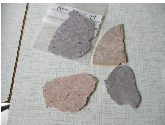
Bilde 24: Viser ulike typer vinylbelegg. Farlig avfall med ftalater.
