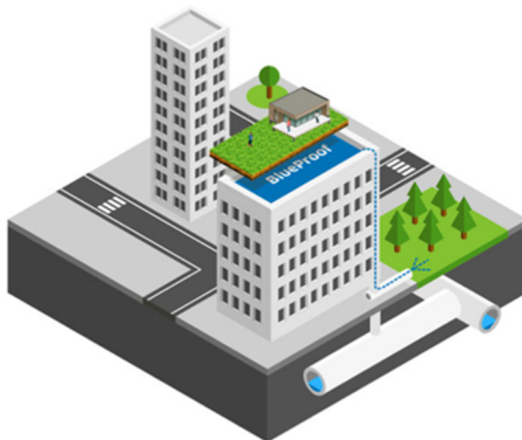
Figur 9: Illustrasjon av Blueproof Green, grønt tak kombinert med overvannsreservoar. Fra protan.no
