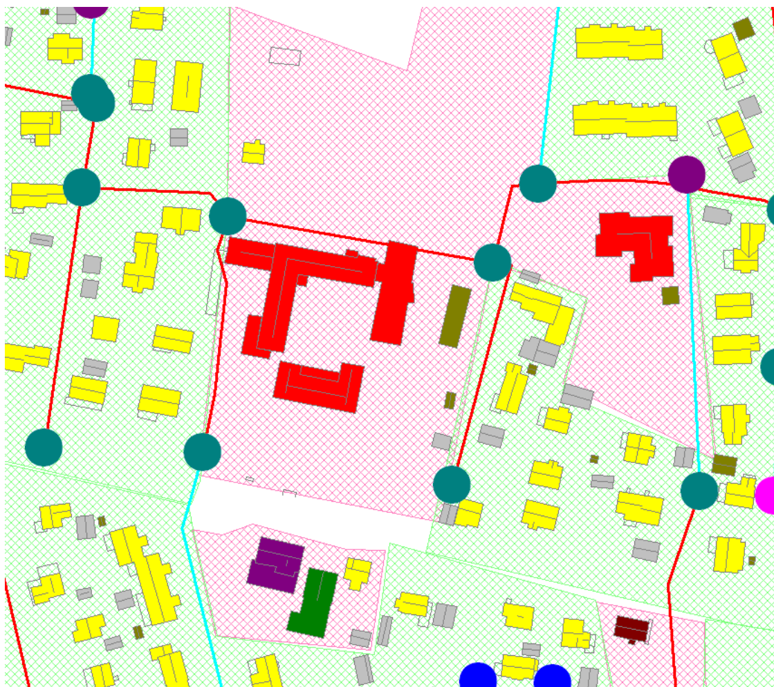
Figur 13: Utklipp fra brannvannskart i Gemini VA hvor grønnfargede sirkler indikerer god kapasitet i forhold til kravet.
