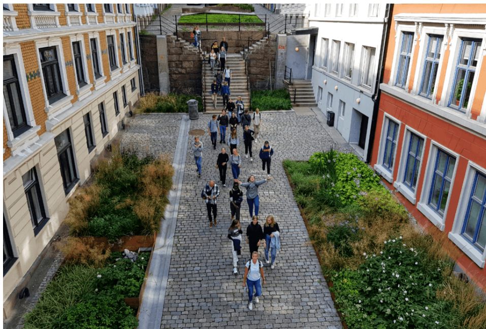
Figur 10: Regnbedene i Deichmans gate og Wilses gate, prosjektert av Asplan Viak, er en pilot for urbane regnbed i Norge. Fra AsplanViak.com
