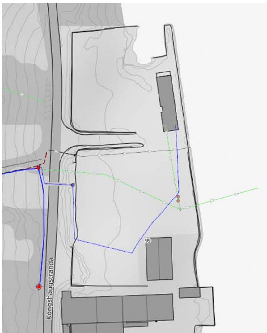
Figur 7 – VA-ledninger på riggområdet
