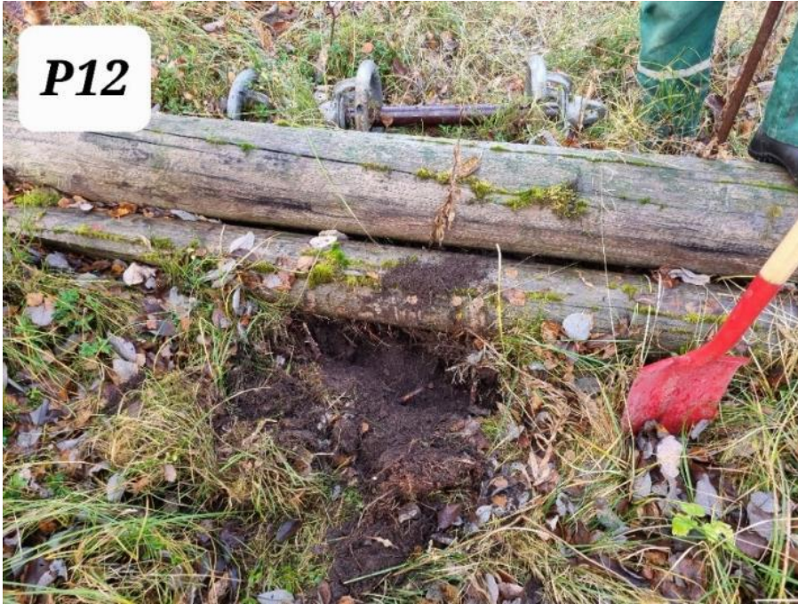
Figur 2-17. Fra prøvetaking av masser under lagerplass for impregnerte stolper. Foto: Multiconsult.
