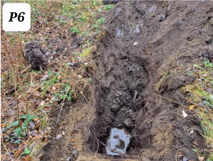
Figur 2-7. Fra prøvesjakt P6 hvor det ble registrert avfall ned til ca. 1,5 meter under terrengoverflaten. Foto: Multiconsult.
