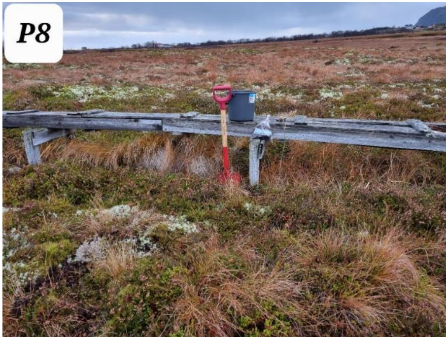
Figur 2-12. Fra prøvegraving under kreosotimpregnert kabelbru, prøvepunkt P8. Foto: Multiconsult.
