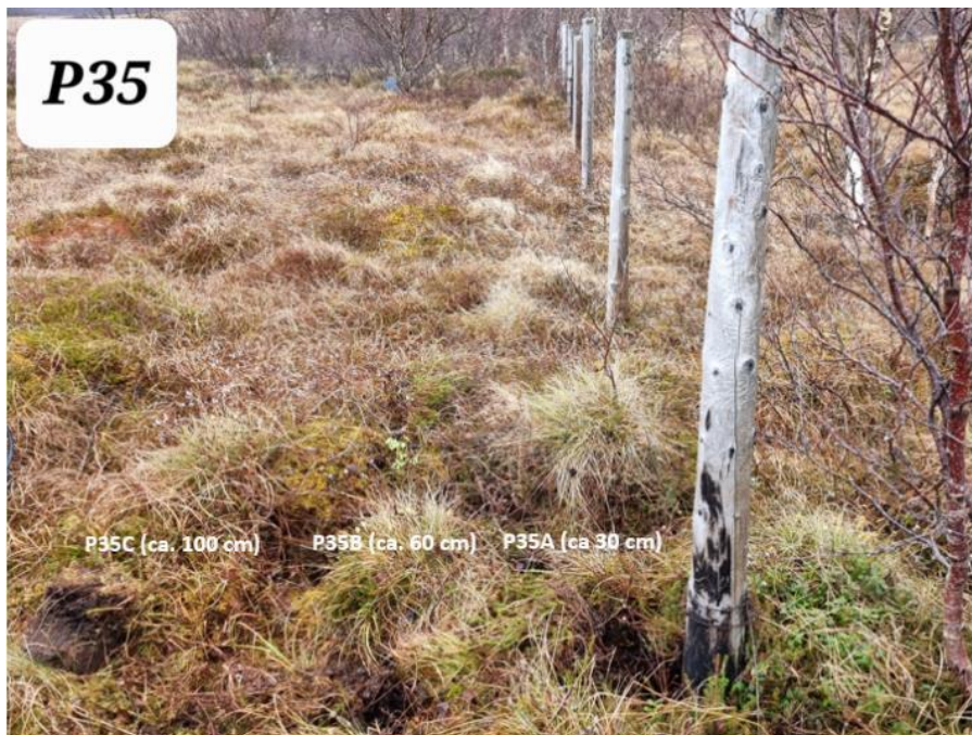
Figur 2-19. Fra prøvetaking av masser rundt gjerdestolper. Her fra prøvepunkt P35 hvor det er tatt prøver på henholdsvis 30 cm, 60 cm og 100 cm fra gjerdestolpen. Foto: Multiconsult.
