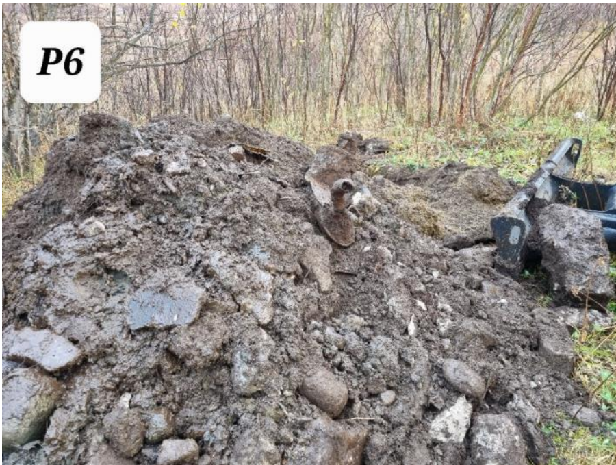
Figur 2-8. Oppgravde masser fra prøvesjakt P6 hvor det ble registrert avfall. Foto: Multiconsult.
