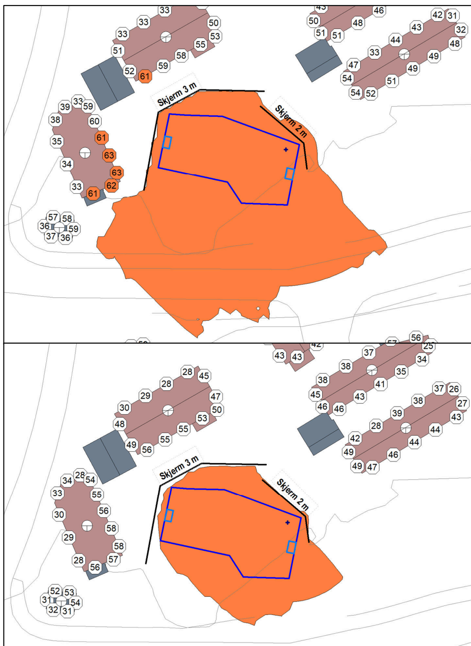
Figur 4-23: Støysonekart med 1,5m beregningshøyde og høyeste fasadenivåer uavhengig av etasje for skjermingsalternativ 2, kildeposisjon 3. Situasjon med 80 km/t ballhastighet er vist øverst, 50 km/t ballhastighet er vist nederst.
