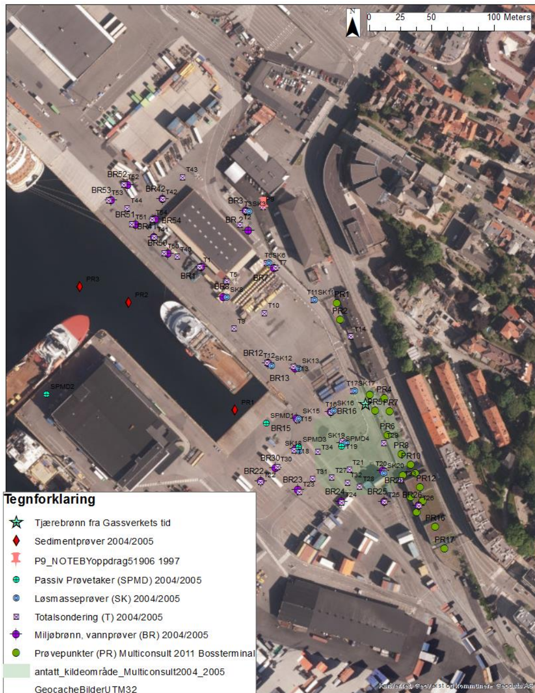
Figur 3. Oversikt over alle prøvepunktene på Gassverktomten. Totalsonderingene (T) er en kombinasjon av modifisert dreietrykksondering og bergkontrollboring, og gir normalt gode opplysninger om løsmassenes lagringsfasthet og lagdeling i tillegg til sikker bergpåvisning ved at boringene normalt avsluttes etter boring i antatt berg. I denne undersøkelsen utført av Multiconsult ble boringene avsluttet etter ca. 2 m boring i antatt berg. Formålet med de utførte totalsonderingene var både å avklare om det var hindringer i grunnen som kunne vanskeliggjøre brønninstallasjon og å bestemme brønnutforming mht. dybde, beliggenhet av filtersone og type brønnfilter. Løsmasseprøvene (SK) ble tatt med skovlbor som gav omrørte, representative prøver. Vannprøver ble tatt i de 25 grunnvannsbrønnene (BR) . BR1-20 ble installert og rensepumpet i juni 2004 og prøvetatt 11. august 2004, BR 22-43 installert og rensepumpet i begynnelsen av november, prøvetatt 22. desember 2004, BR 50-54 installert og rensepumpet i begynnelsen av mars 2005 og prøvetatt 29. mars 2005. Vannprøvetaking ble utført på fallende tidevann. SPMD – passive prøvetagere kan trekke til seg miljøgifter fra vann og ble satt ut i BR19 og BR18, samt i sjøen ytterst på Dokkeskjærskaien (SPMD2) i tillegg til i sjøen innerst i Jekteviken (før rampeområdet ble utfylt), punkt SPMD1. Sedimentprøvetaking ble utført 1. februar 2005, i tre punkter i sjøen og ble tatt ved å presse prøvesylindere ned i sedimentet i punktene PR1-3 . I 2011 ble det tatt prøver i punktene PR1-17 på den planlagte tomten til Bossterminalen til BIR med geoteknisk borerigg.
