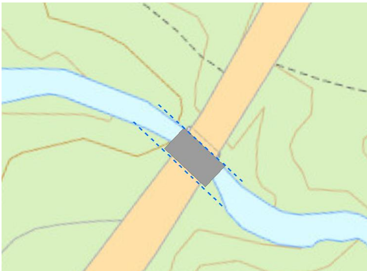
Figur 7-1. Forslag til plassering av ny bru. Blå stiptet linje indikerer nye bredder for bekkebunnen.
