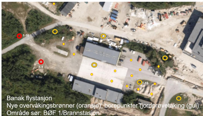
Figur 2 Brønn (sirkel) og prøvepunkt plasseringer (gule punkter) ved brannstasjonen
