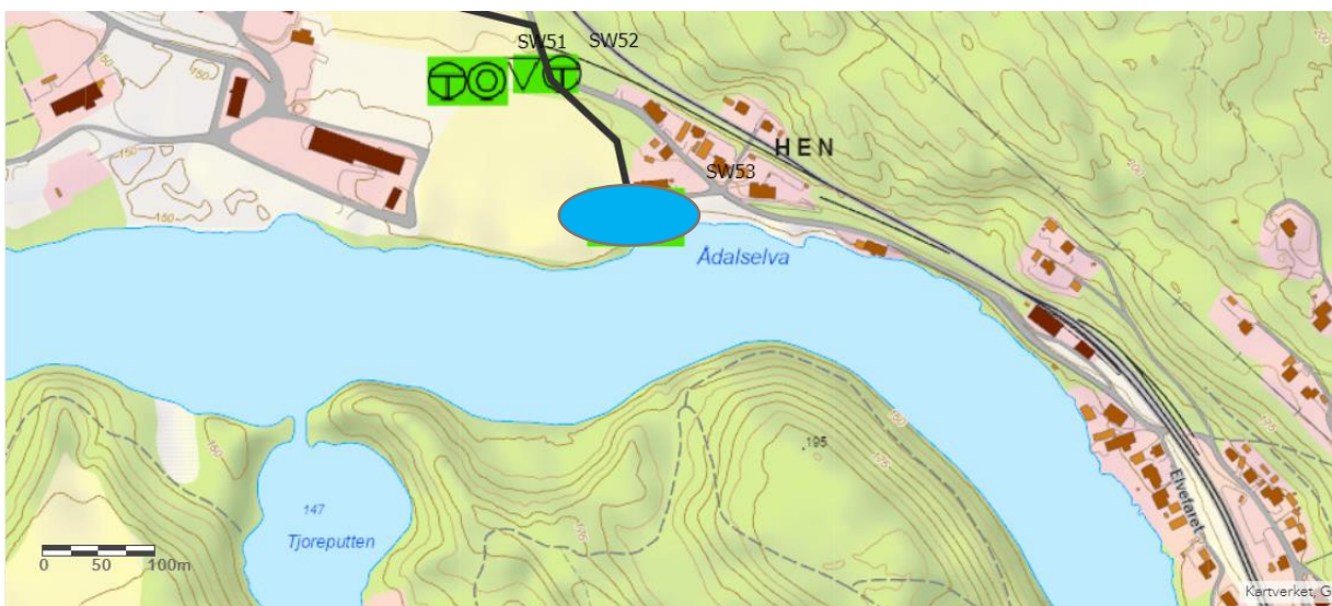
Figur 7.4.1: Massehåndteringskart for massene langs den planlagte traseen Hen-Kilemoen. Det blå feltene viser at massene ved SW 53 er rene i tilstandsklasse 1 (Sweco, 2023).
