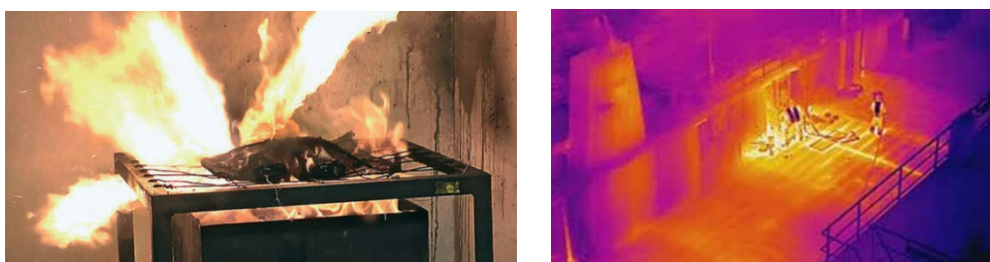
Figur 3.55 Eksempler «thermal runaway» av batterier, celle og installasjon
