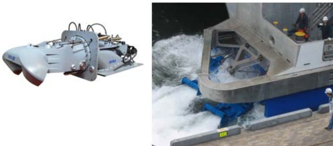
Figur 3.5 Øverst: Eksempel på vribar propell arrangert i halvtunnel (Servogear), Nederst: Vannjet med styredyse og reverseringsdyse (t.v.: MJP, t.h.: Wärtsilä)
