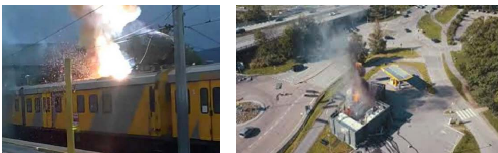
Figur 3.57 Eksempler elektrisk lysbue, eksplosjon Sandvika hydrogenfyllestasjon
