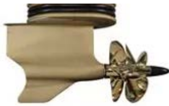
Figur 3.6 Trekkende thruster, eksemplifisert ved Volvo Penta IPS-system
