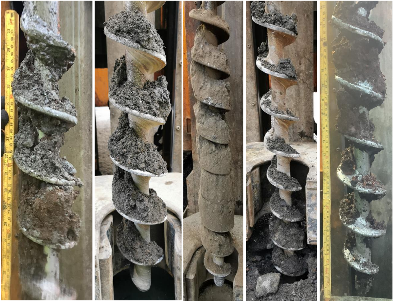
Figur 3. Foto fra felt viser skovl/naver med prøvetatte masser, fra venstre: G104-E (4-4,5 m dybde), G105-A (0,2-0,5 m dybde), G108-A (0,5-1 m dybde), G109-A (0,4-1 m dybde), G110-D (3-4 m dybde).
