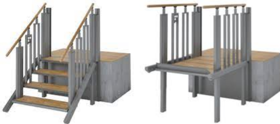
Figur 2.8.1-1 Illustrasjon av kombinert trapp- og løfteplattformløsning.
