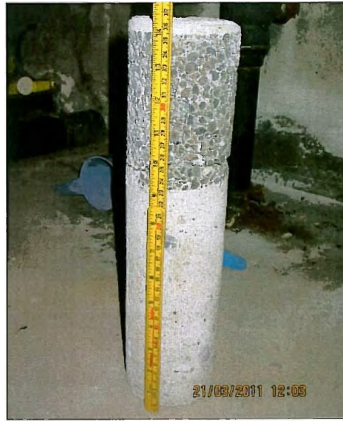
Foto 22: Utboret "kjerneprove" fra kjellervegg. Viser 200 mm betong og 120 mm Leca.
