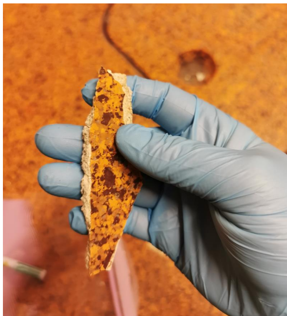
Bilde B1: Prøve nr. 1, avretting og gul/brun gulvoverflate i gang.
