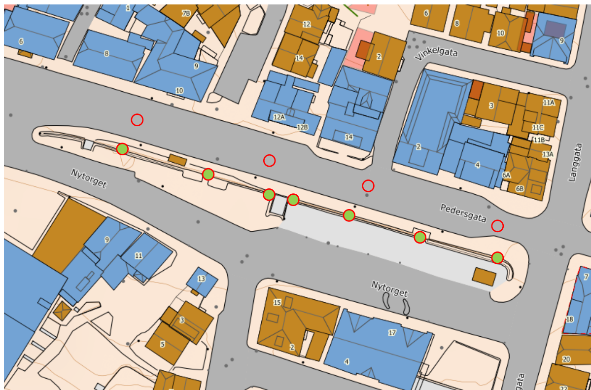
Figur 13 Forslag til plassering av setningsmålere (rød sirkel) og rystelsesmålere (grønt fyll)
