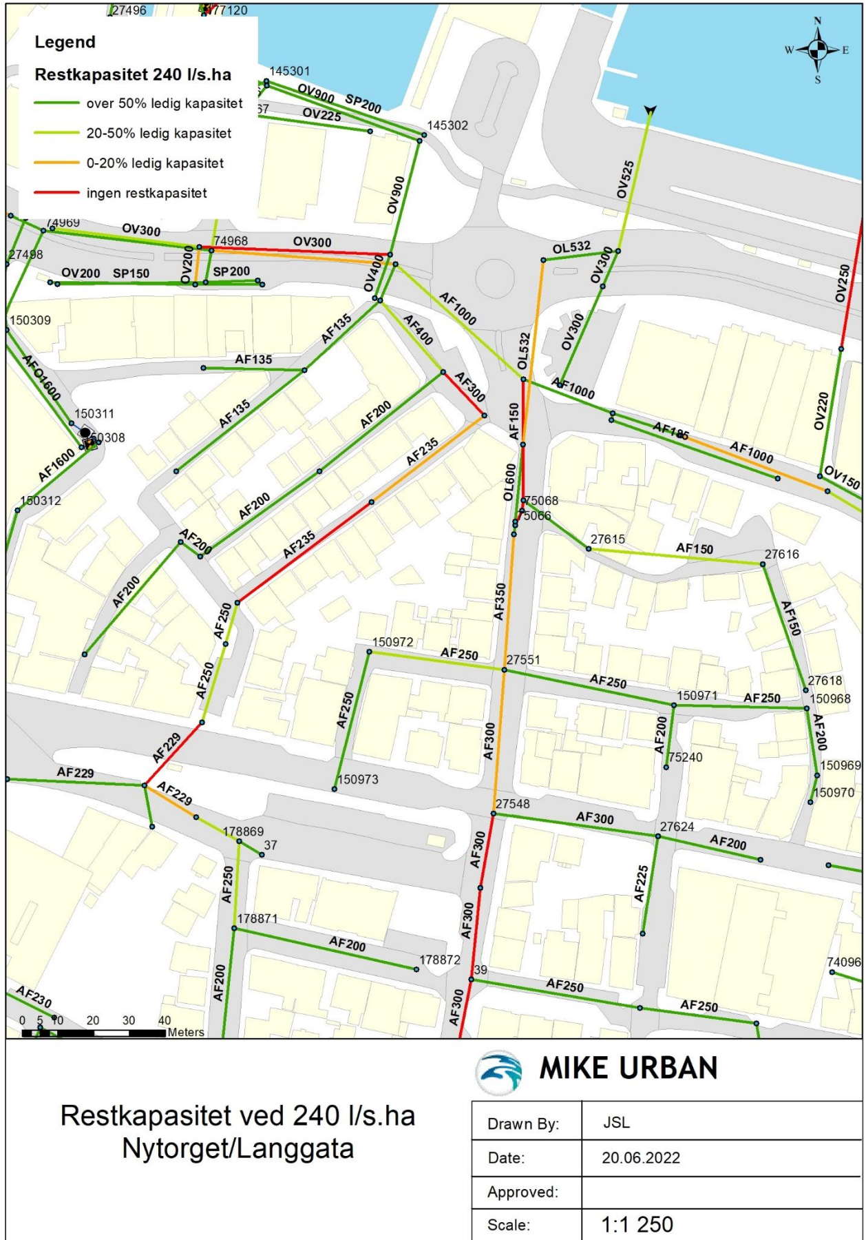
Figur 2: Restkapasitet (Q/Q Manning) ved 20 år + 20%, 243 l/s.ha – Nytorget
