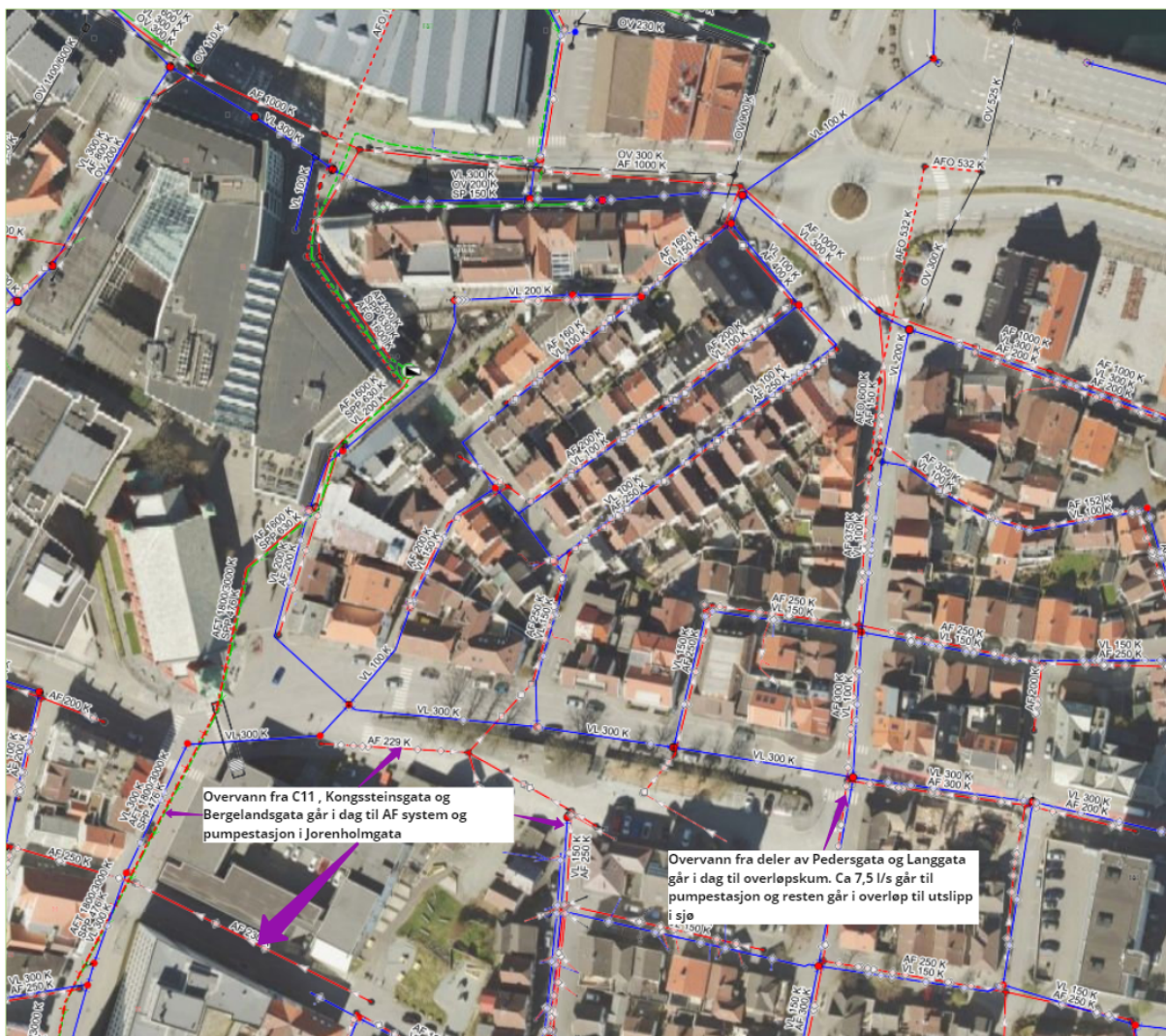
Figur 1: Eksisterende situasjon for avløp innenfor prosjektområde «C11» og «Nytorget Park og VA». AF fra C11 og Nytorget føres idag til eksisterende pumpestasjon. Nedstrøms i Langgata går hovedmengden av avløpsmengdene direkte til utslipp i sjø ved kai.
