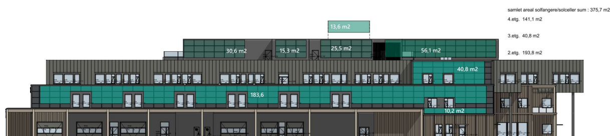
Figur 2: Utsnitt fra fasadetegning av vestfasaden. Området som er anslått som mest effektivt nyttbart med hensyn til tilgjengelig plass og solinnstråling er markert med grønt.
