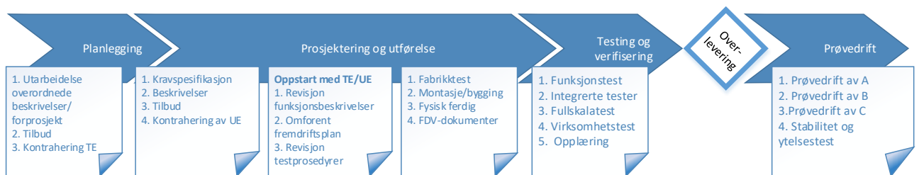
Figur: Prosessen frem til overlevering og prøvedrift (Kilde: Veileder BA2015: Systematisk ferdigstillelse).
