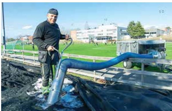
Oppsamlingsenhet for oppsuging av granulat, kompatibel med kunstgressstraktoren (KE Consulting AS).
