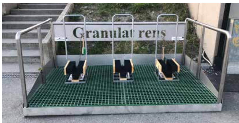
Granulatrensestasjoner med integrerte filter. Denne løsningen krever ikke mekanisk installasjon eller gravearbeider. Foto: Miljøbaner.
