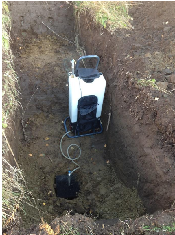
Figur 2.1 Bildet viser oppsett av infiltrrometer for gjennomføring av infiltrasjonstest.
