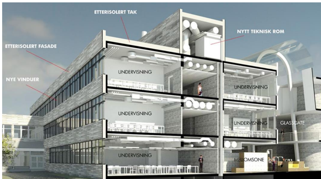
Fig. 3 – Prinsippskisse fasade og snitt teorifløy med ny situasjon.
