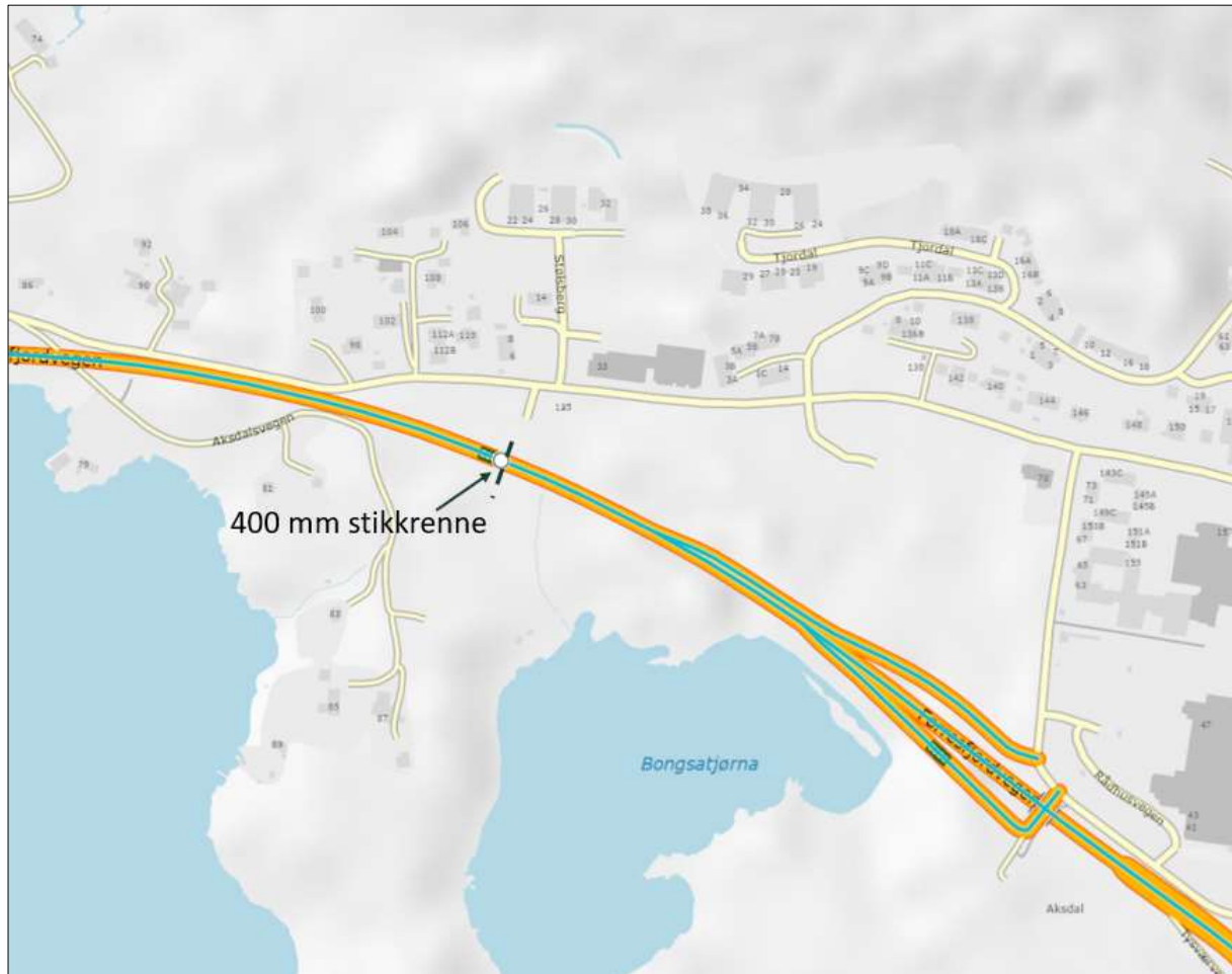
Figur 5: Planområdet drenerer til en 400 mm stikkrenne under E134. (Kilde: vegkart.atlas.vegvesen.no).
