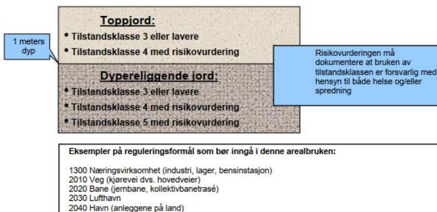
Figur 3-1.: Det aktuelle området har en arealbruk tilsvarende «Industri og trafikk» i TA-2553/2009, og følgende tilstandsklasser er tillatt i hvilke dyp.
