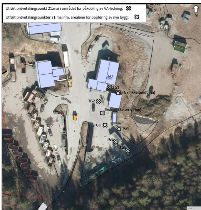
Figur 1-2. Swecos prøvepunkter fra miljøteknisk grunnundersøkelse 03.06.2021. Kilde: Sweco.
