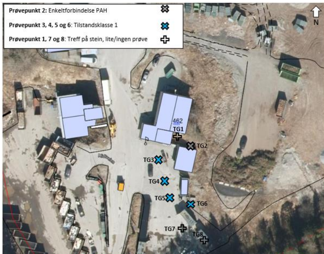
Figur 4-1 Påvist forurensning ved Teigen gjenvinningsstasjon. Prøvepunktene er markert med farge etter tabell 3-2 i henhold til påvist tilstandsklasse. Blå prøvepunkter, tilstandsklasse 1. Grå farge (prøvepunkt 2) viser overskridelse av PAH med normverdi. Prøvepunkt 1, 7 og 8 er ikke farget, for det var treff på fjell, så de er ikke sendt til analyse. Kilde: ©Kommunekart
