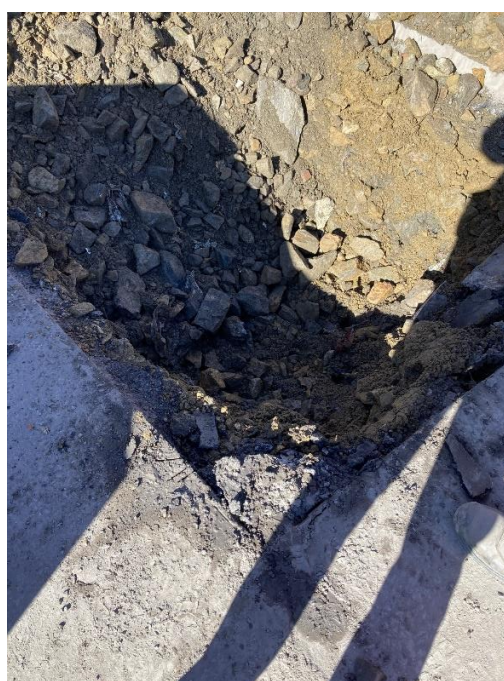
Figur 2: Bilde til venstre er tatt av prøvegravning 3 framfor farlig avfallsbygget og viser faste masser av hovedsakelig spengstein. Prøvegravning 2 var med sandig. Prøvegravning 4 til høyre indikerer egnethet av overliggende fyllingsforsegling og viser forholdsvis mye friksjonsmasser.
