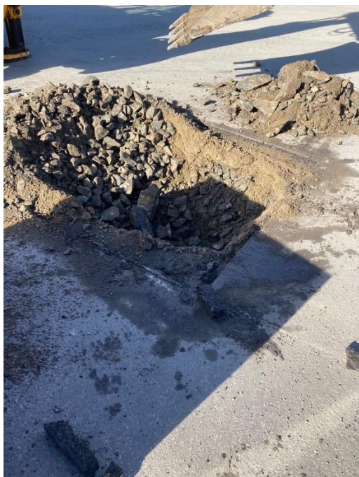
Figur 2: Bilde til venstre er tatt av prøvegravning 3 framfor farlig avfallsbygget og viser faste masser av hovedsakelig spengstein. Prøvegravning 2 var med sandig. Prøvegravning 4 til høyre indikerer egnethet av overliggende fyllingsforsegling og viser forholdsvis mye friksjonsmasser.
