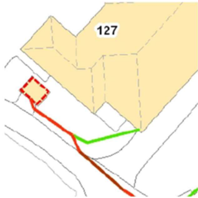
Figur 2: Høyspentkabel i rødt, med stikkledning til Hordnestunet i grønt
