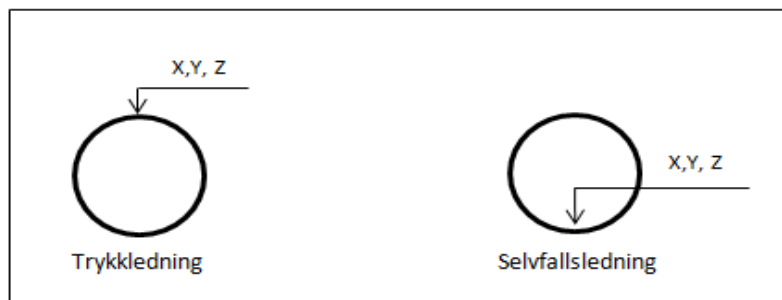
Figur 1. Måling av ledningshøyde.
