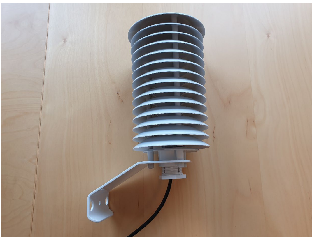
Figur 2 HMP77 probe plassert i strålingshytte
