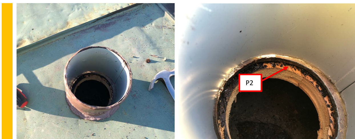
Figur 5 Takpapp (P2) under kobbertekking på tak over Store studio. Prøven inneholdt ikke asbest.
