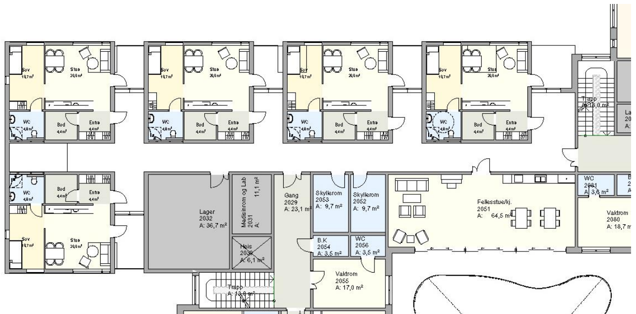
Fløy B – Eksempel på løsning med omsorgsboliger
