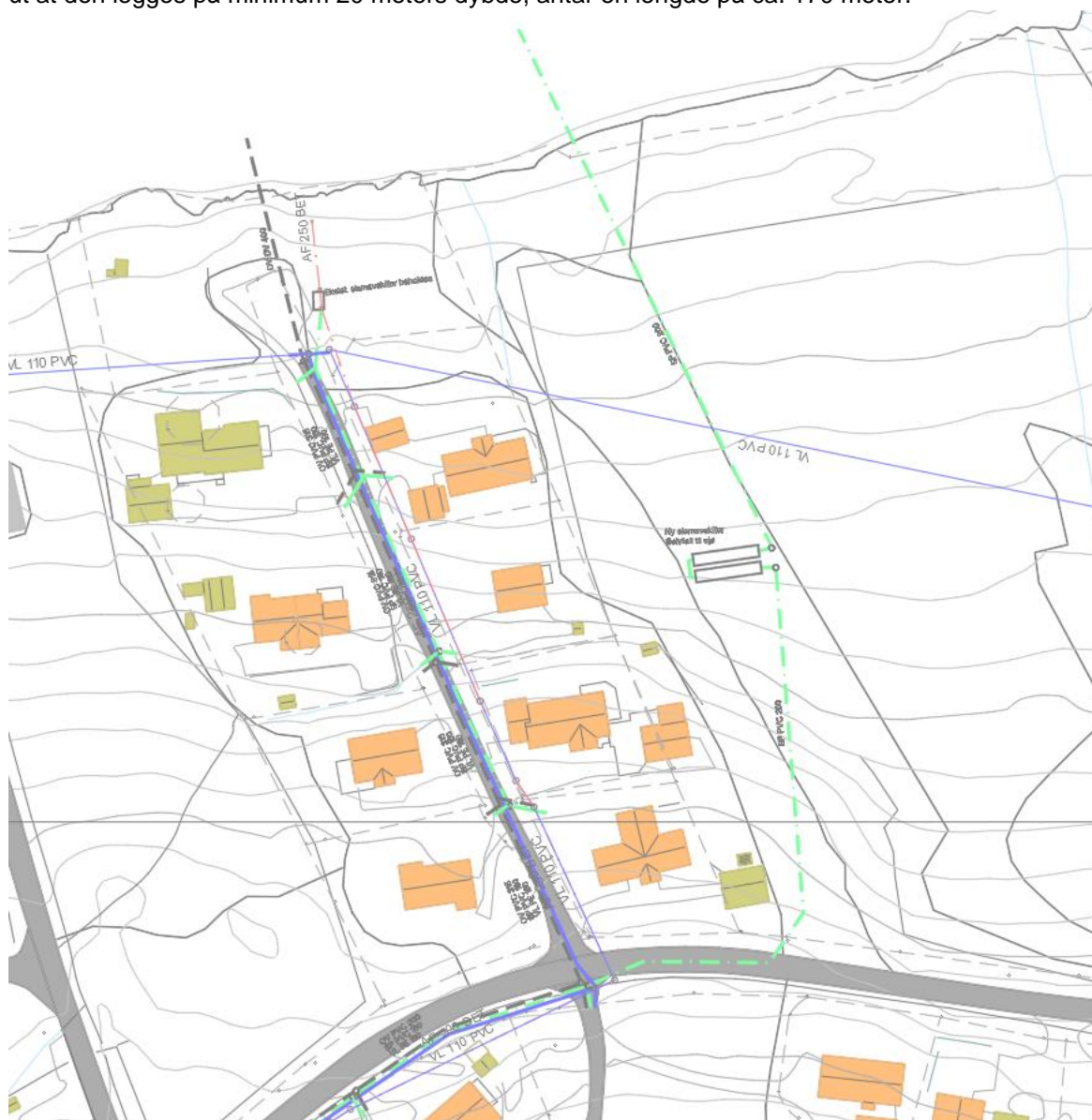
Figur 2 Alternativ 1b - Tradisjonell slamavskiller uten pumping til sjø
