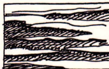
Afskalning (Alkydmaling og Plastikmaling)
