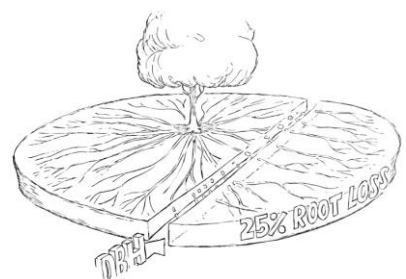
Illustrasjonen viser hvor mye av rotsystemet som blir påvirket selv om en overholder anbefalte minsteavstand (kilde. Arborist News)
