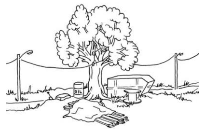
All lagring av materiell nær trær må unngås (kilde. Sintef Byggforsk)
