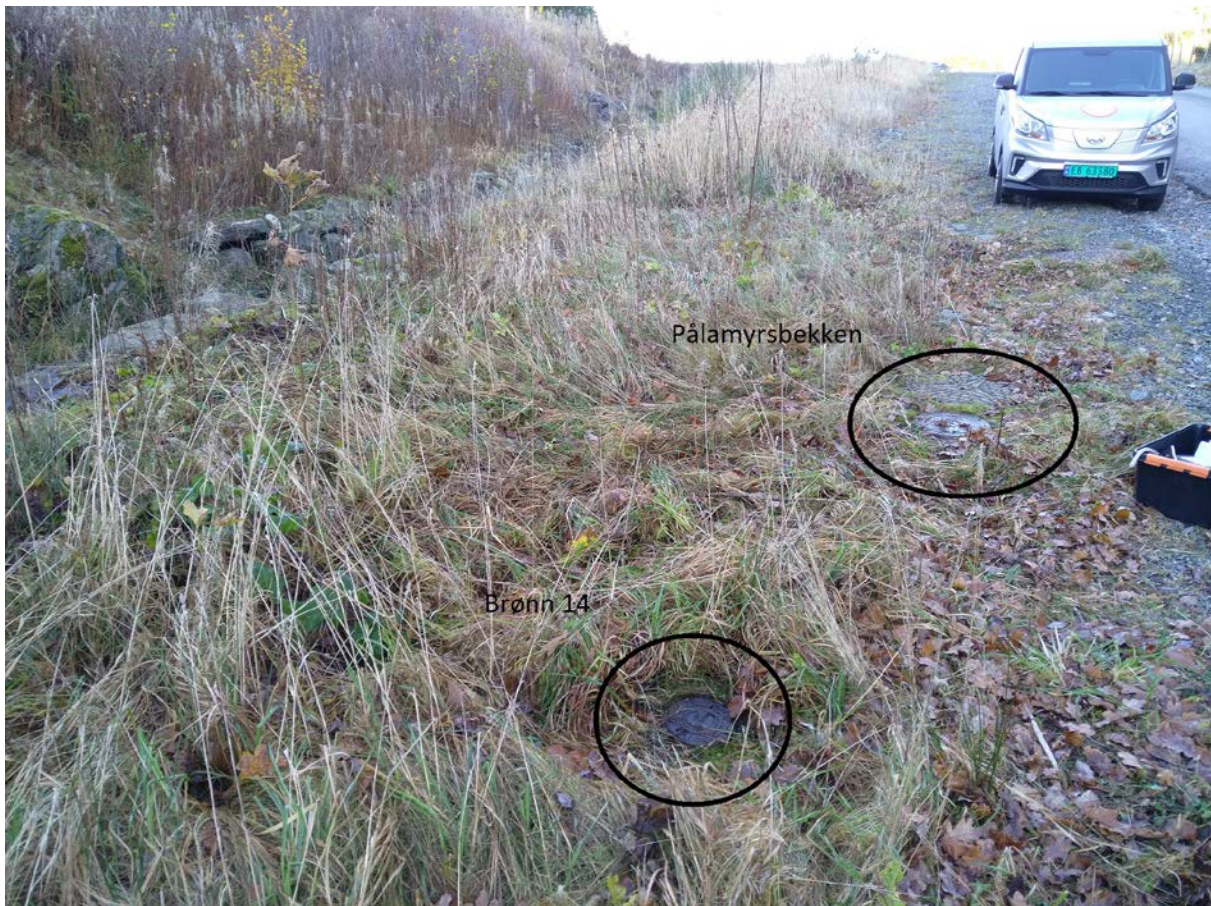
Figur 9. Brønnhode for brønn 14. Brønnene er en dyp fjellbrønn som gir grunnvann som er representativ for vann som renner i sørlig retning mot Melkevikken. Bekk for avledning av overflatevann vist til venstre på bildet.
