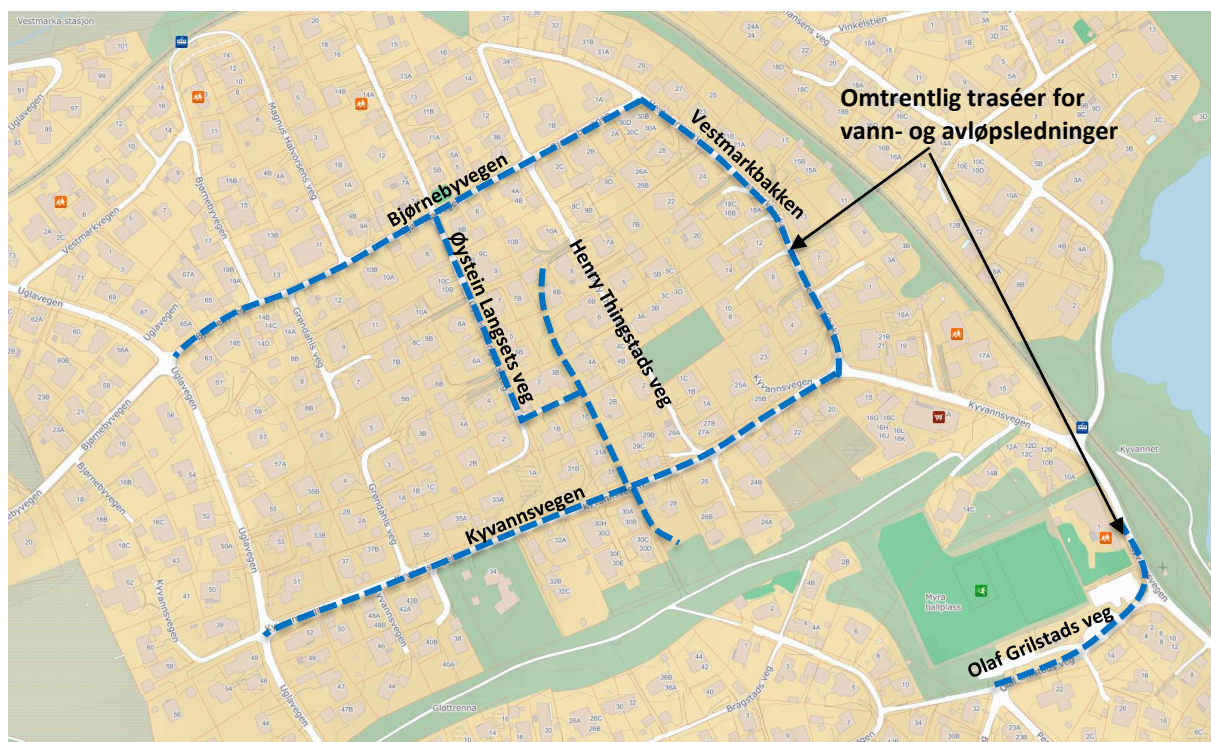
Figur 4-1 Oversiktstegning med omtrentlig plassering av traséer for vann- og avløpsledninger. (Kilde ?)
