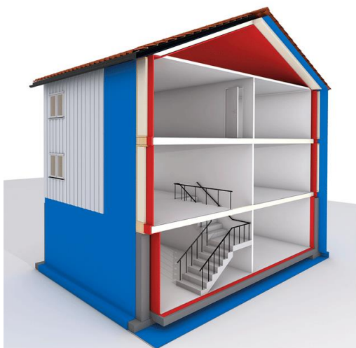
Figur 6-1 Prinsipp for kontinuerlig sperresjikt i klimaskjerm. Blå farge viser vindsperresjiktet og rød farge viser dampspærresjiktet. Figur fra BKS 520.401 (2013).
