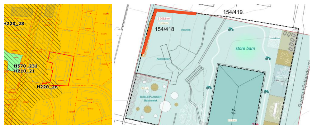
Figur 13. Plankart med støysone (skravert) og skjermingstiltak.
