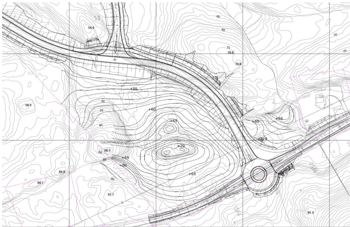
Figur 22 Illustrasjon som viser hvordan deponiområdet kan arronderes, nye koter med stiplede linjer.
