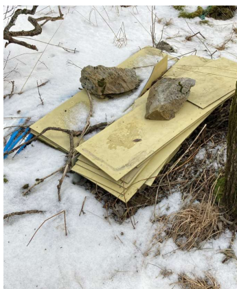
Bilde 36. Eternittplater utenfor Holmsveien 2057 leveres som farlig avfall med asbest
